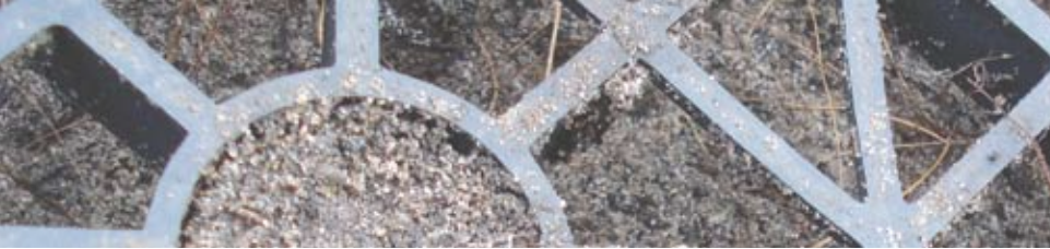
In de luchtlaag boven in het permavoidelement bevinden zich dunne, rondjes draaiende wortels.
